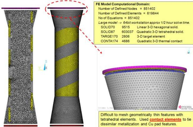
Fig. 6:  $6\sigma$  Finite Element Sub-Model.
