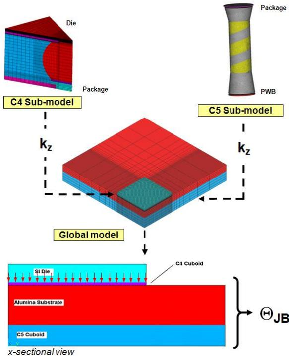
**Fig. 4: Thermal Sub-Modeling Methodology.**
